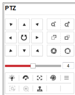
図 4-3 PTZ コントロールパネル
