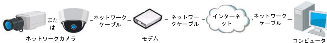
図 2-11 動的 IP を持つカメラによるアクセス
