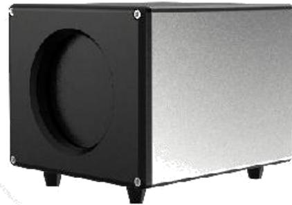
標準放射源として、黒体は赤外線システムの校正、材料の放射率の測定、赤外線センサーのパラメータの測定、赤外線エミッターと熱デバイス間の温度伝達に広く使用されています。
