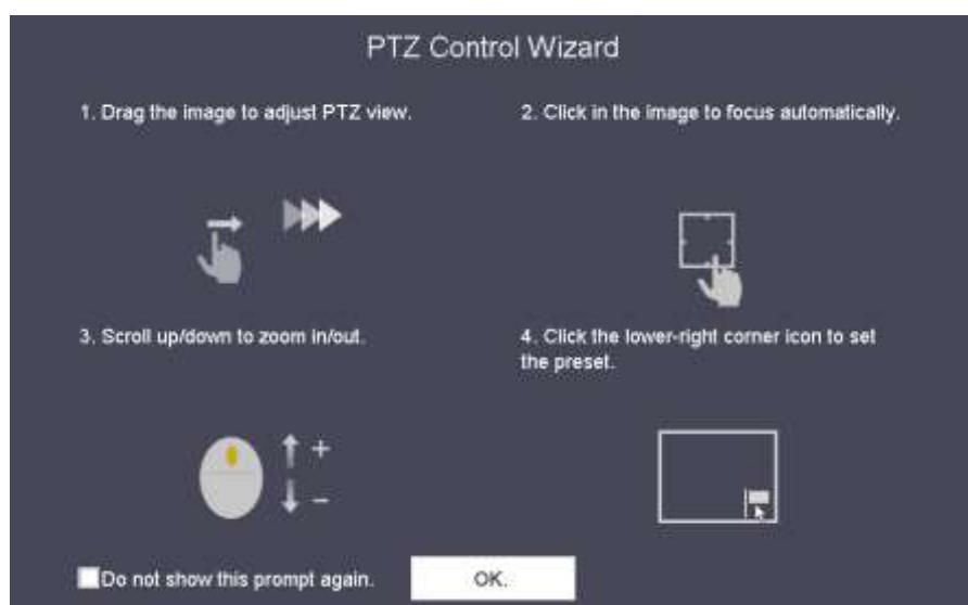
図 6-1 PTZ コントロールウィザード
