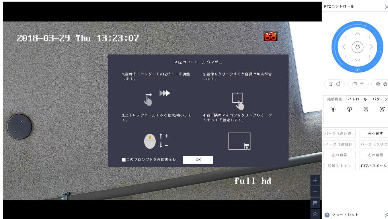
2 表示されたポップアップ画面に従い、焦点およびズームイン/アウトを調整
